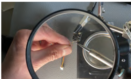
Verlöten der Anschlüsse an das Sendermodul
